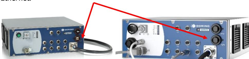
A termine dell'installazione, collocare accanto al connettore Ethernet l'adesivo EtherNet/IP fornito con il kit di ricambio.
